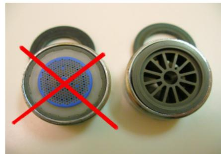
Verwenden Sie nur noch die neuen Strahlbrecher, sie sorgen dafür, dass das Wasser mit dem richtigen Druck ordentlich fließen kann (Die Fein-Perlatoren verhindern dies). Falls sich doch Kalk ansetzt: in Essigwasser erhitzen und reinigen.
